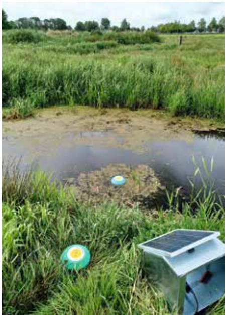
Sensoren in oppervlaktewater, een nieuwe methode voor het meten van de waterkwaliteit.
