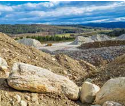
Voorbeeld van dagbouw in onze directe woonomgeving: de winning van grovere en fijnere steenfracties voor de onverharde wegen in Jämtland. foto Frank Heijns
