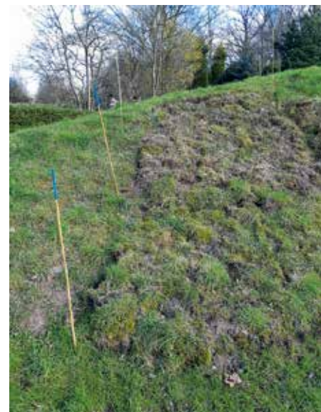
Op het talud van de heuvel op landgoed Larenstein met de iconische boom zijn soortenrijke plaggen gelegd. Hier wordt bestudeerd hoe de vegetatie zich ontwikkelt en welke manier van aanbrengen geschikt is voor versterking van rivierdijken.
